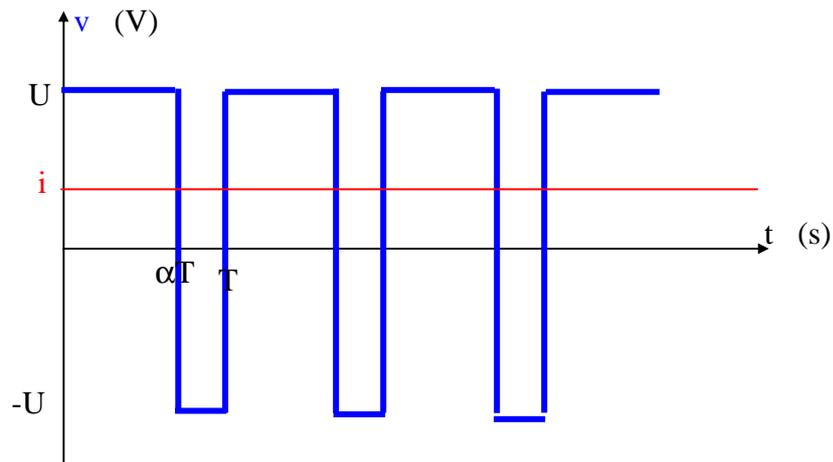
$0 \text{ à } \alpha T : T_1 T_4 \text{ fermés donc } v=U$
